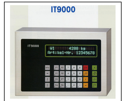
frei Programmierbares Anzeigergerät bis zu 4 Waagen anschließbar div. hochwertige Standardprogramme lieferbar, z.B. Rezeptur, Abfüllung, Dosieren, BigBag usw.
